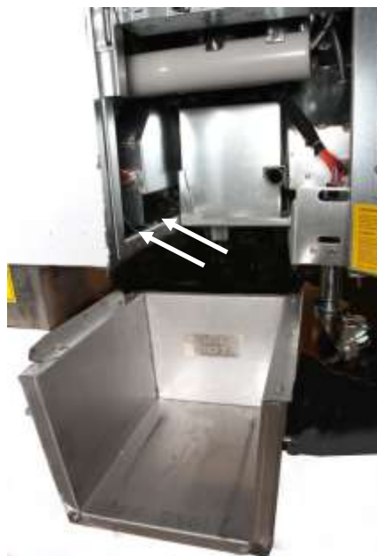
Bild 1: Placera smältaren i skåpet och fast med medföljande skruvar inne i skåpet.
