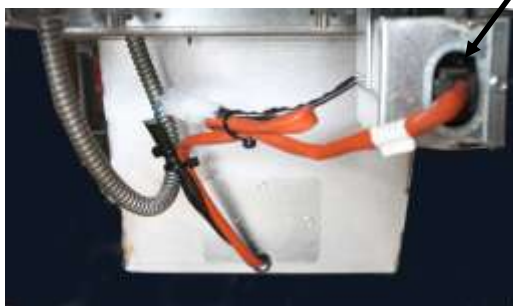
Bild 3: Anslut den svarta kopplingen till uttagslådan såsom visas. Ett separat don med en vit plugg, om sådant finns, används INTE .
